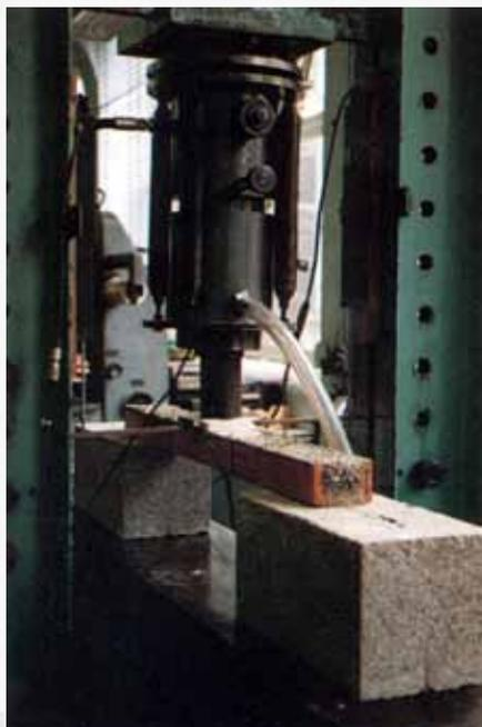
La capacité portante de l'ensemble résulte à la fois de la résistance à la traction du prélindeau, de la résistance à la compression et au cisaillement de la maçonnerie qui le surmonte (blocs béton), mais aussi de la résistance au cisaillement du joint entre le béton du prélindeau et le mortier de pose de la maçonnerie.
